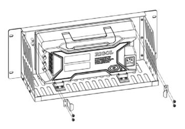
5. 装入机柜:用 4颗 M6 螺钉和 4颗 M6 方螺母将固定好仪器的机架安装在 19 英寸标准机柜内。
